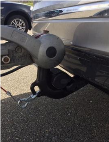
Korrektes Anbringen direkt am Fahrzeug (mit Öse).
